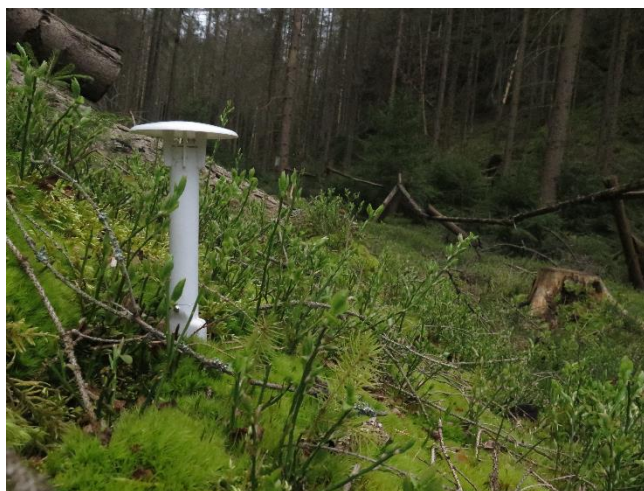
Mikroklimatické čidlo pro měření teploty vzduchu 15 cm a 2 cm nad povrchem půdy, teploty půdy 8 cm pod povrchem a vlhkosti svrchní vrstvy půdy do hloubky 15 cm umístěné v NP České Švýcarsko (foto M. Man).
